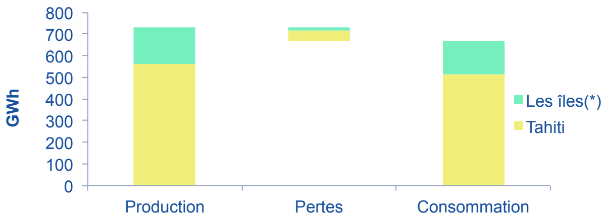
Figure 2-4 Production, consommation et pertes pour Tahiti et les îles en 2010
